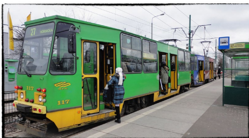
fot. Michał Jagusiak Poznań - Tramwaj dwukierunkowy z drzwiami tylko po prawej stronie
