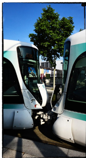
fot. Michał Jagusiak Paryż - Sprzęg tramwajów przegubowych
