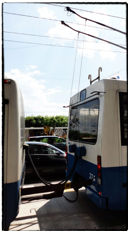
fot. Michał Jagusiak Lucerna (Szwajcaria) - Połączenie trolejbusu z przyczepą
